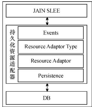
图 3 持久化资源适配器的整体结构
