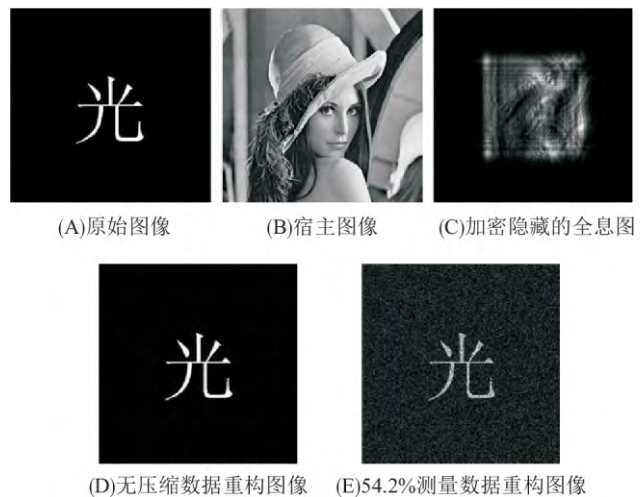
图 4 具有加密和隐藏功能成像系统的仿真结果
